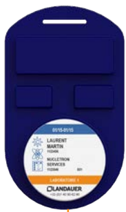
Dosimètre de criticité intégrant IPLUS et Neutrak
