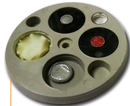
Fig. 2 : Intérieur du dosimètre de criticité Disposition des différentes pastilles
