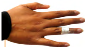
Exemple d'utilisation de la pastille TLD pour une mesure des extrémités
